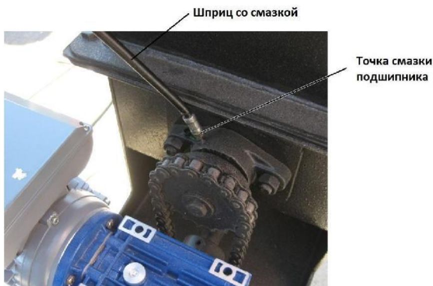
Рисунок 14. Смазка подшипников шнековой подачи.
