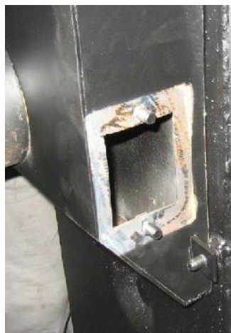
Рисунок 16. Отверстие для чистки адаптера дыма
